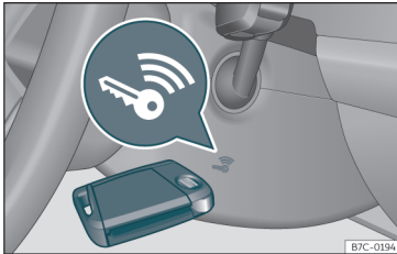
Joonis 140 Roolisamba paremal küljel: kontakt-pind hädakäivituseks
