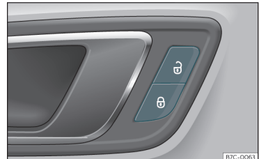
Joonis 75 Juhiuks: kesklukustuslülit
