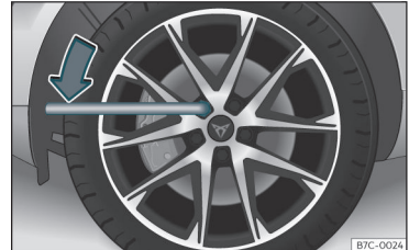
Joonis 34 Ratta vahetamine: rattapoltide lahtikeeramine
