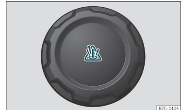
Joonis 205 Mootoriruumis: jahutusvedeliku paisupaagi kork
