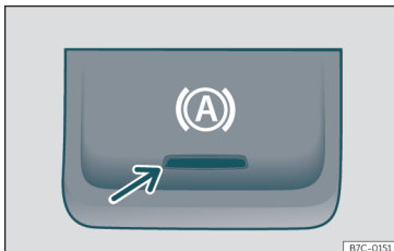
Joonis 176 Keskkonsooli alumises osas: automaatse seisupiduri (Auto Hold) lüliti
