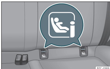
Joonis 25 Tagaistmel: ISOFIX-/i-Size-kinnitusaasad
