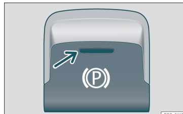
Joonis 175 Keskkonsooli alumises osas: elektroniline seisupiduri lüliti
