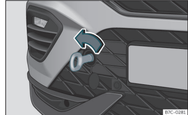
Joonis 42 Esikaitseraua paremal pool: sisse keeratud pukseerimisaas
