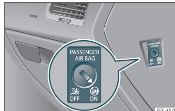
Joonis 15 Lülitati esiistmel istuva kaassõitja esiturvapadja sisse- ja väljalülitamiseks
