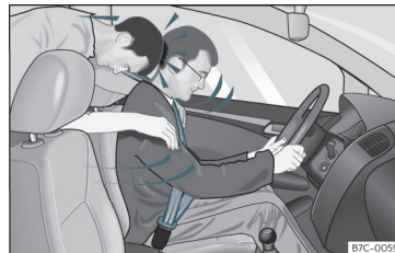
Joonis 8 Turvavööta tagaistuja paiskub suure hooga ette vastu turvavööga kinnitatud autojuhti.
