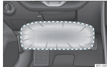
Joonis 18 Juhikohal: põlveturvapadja täitumispiirkond
