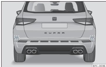
Joonis 151 Auto tagantvaade: radarandurite asukohad
