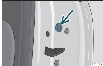
Joonis 80 Avariilukk ukse käsitsi lukustamiseks
