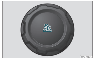
Joonis 218 Mootoriruumis: jahutusvedeliku paisupaagi kork
