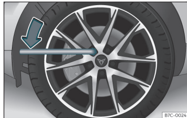
Joonis 41 Ratta vahetamine: rattapoldite lahtikeeramine
