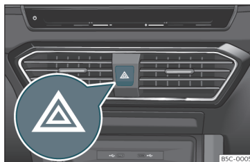
Joonis 96 Armatuurlaal: ohutulede lüliti
